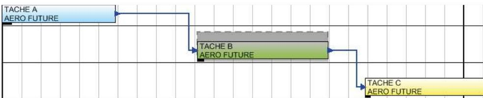
Lorsqu'on déplace la tâche B (vers la droite ou la gauche) en maintenant Alt enfoncé, les tâches en amont (A) et en aval (C) se retrouvent déplacées au plus près de la tâche B :
